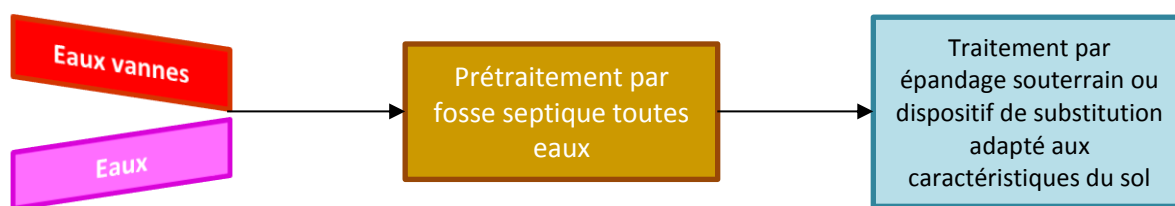
Figure 14 : Schéma d'une installation d'assainissement non collectif
