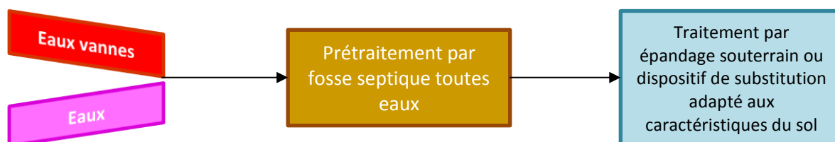
Figure 14 : Schéma d'une installation d'assainissement non collectif
