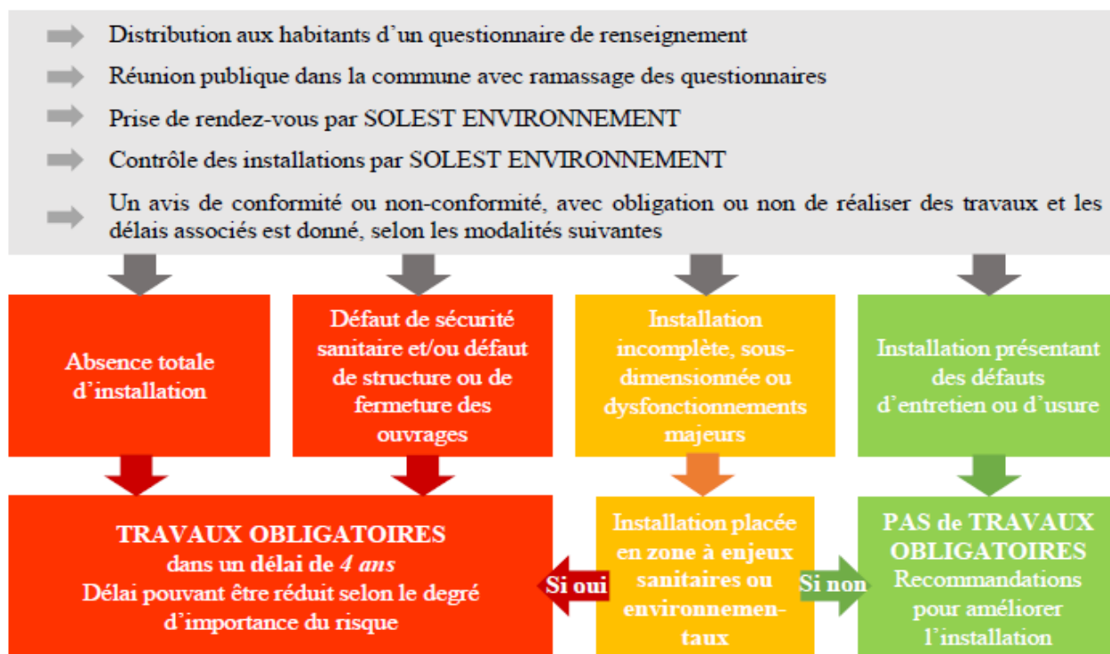
Procédure de contrôle des installations existantes
