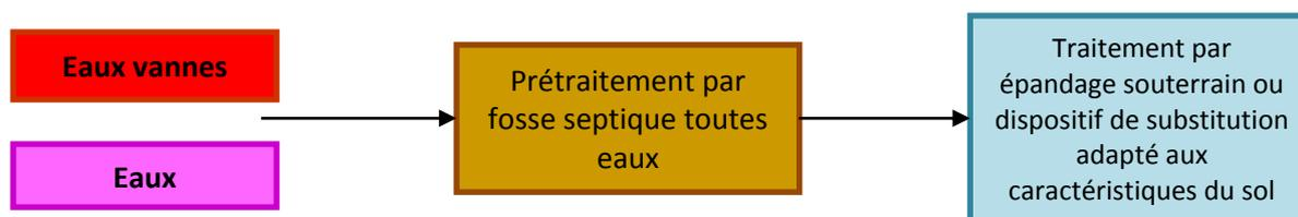
Figure 22 : Schéma d'une installation d'assainissement non collectif
